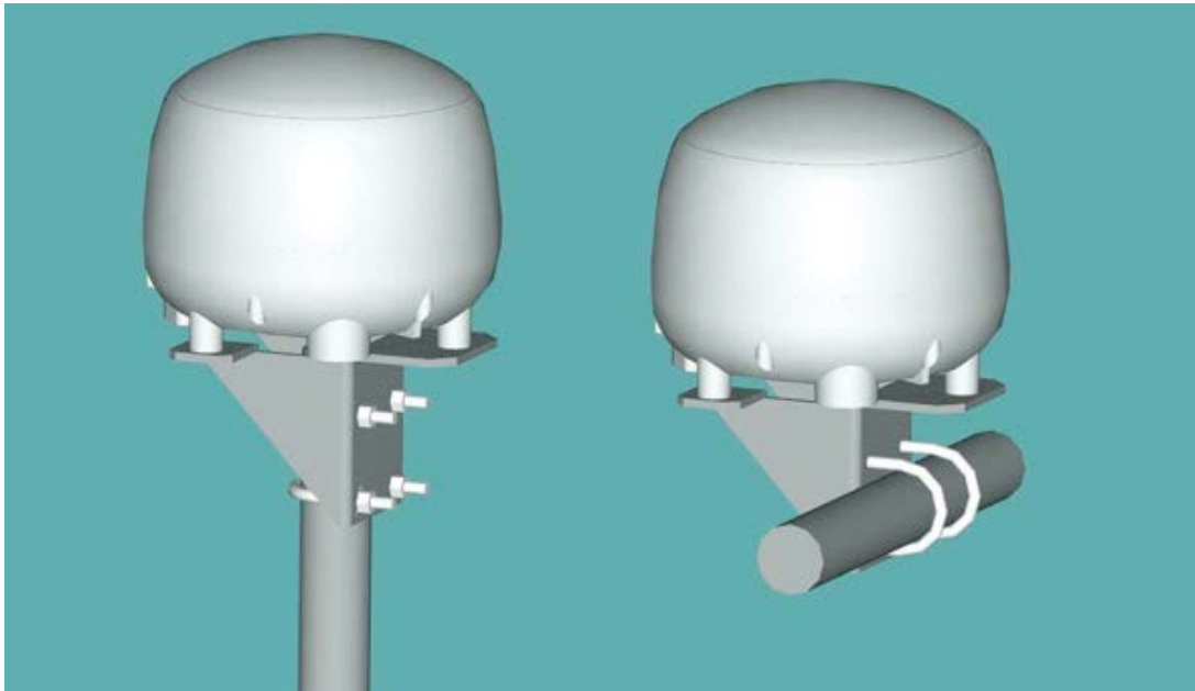
Рис. 6: Установка куполообразного блока на мачту и на поручень
